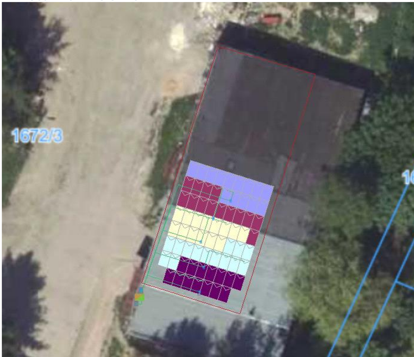
Rysunek 2: Umieszczenie generatora fotowoltaicznego i grupy przetwornic
