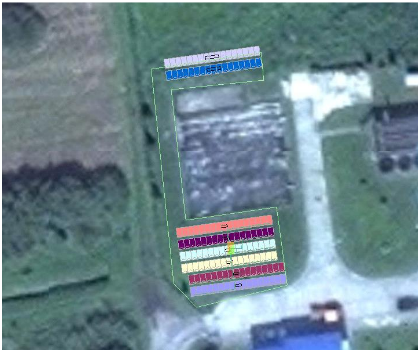
Rysunek 2: Umieszczenie generatora fotowoltaicznego i grupy przetwornic
