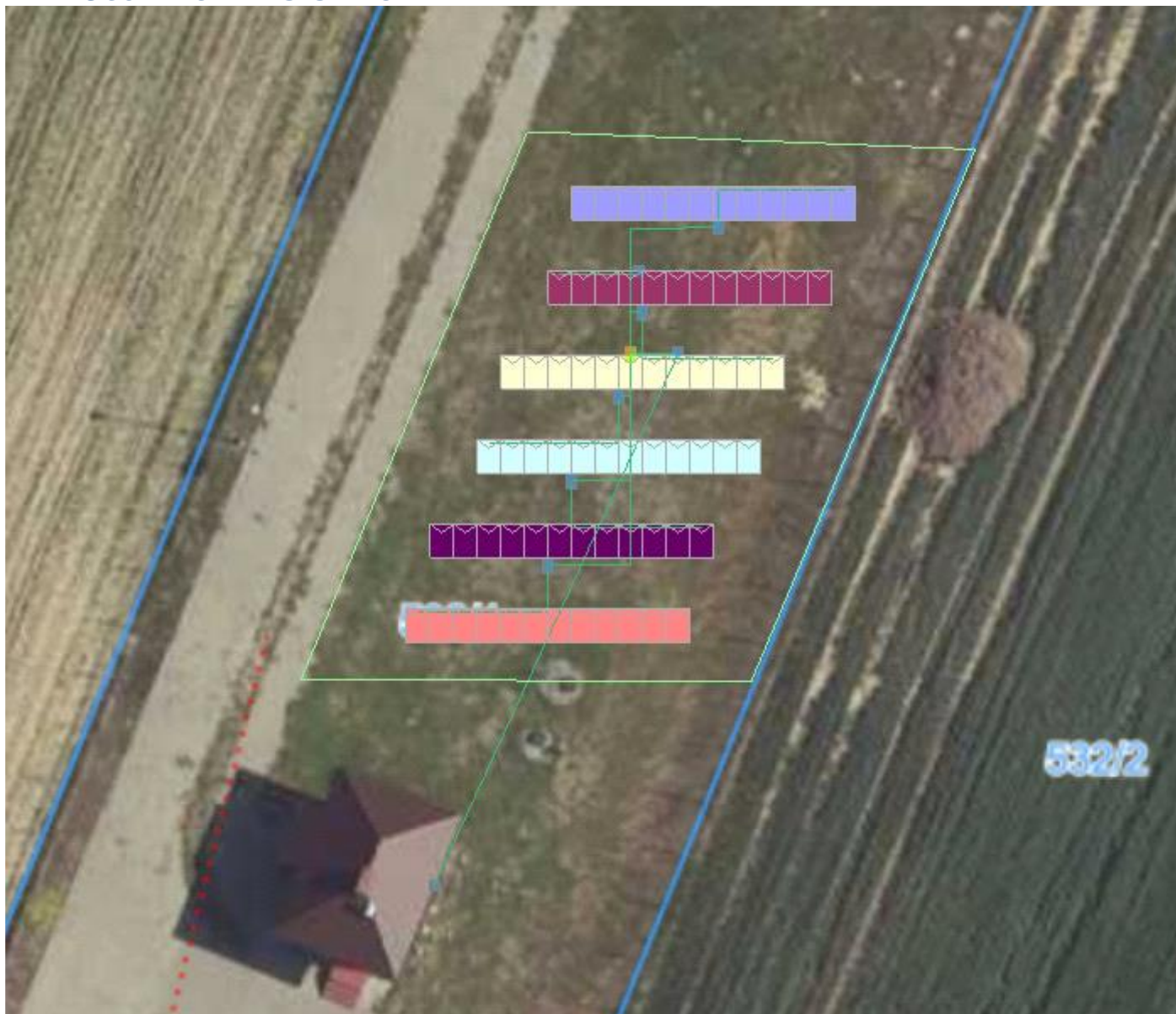
Rysunek 2: Umieszczenie generatora fotowoltaicznego i grupy przetwornic
