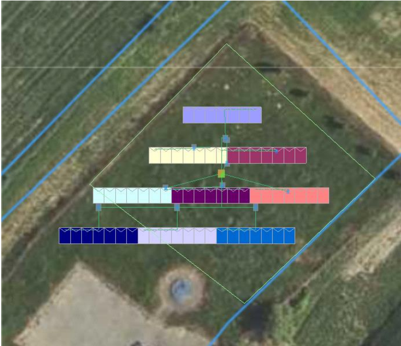
• Rysunek 2: Umieszczenie generatora fotowoltaicznego i grupy przetwornic
