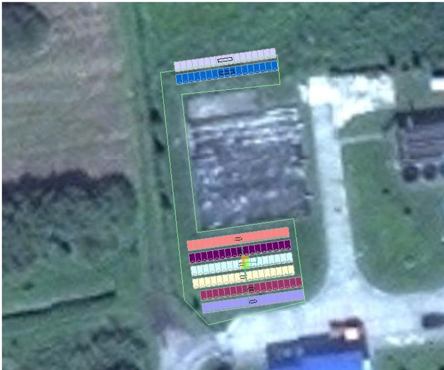
Rysunek 2: Umieszczenie generatora fotowoltaicznego i grupy przetwornic
