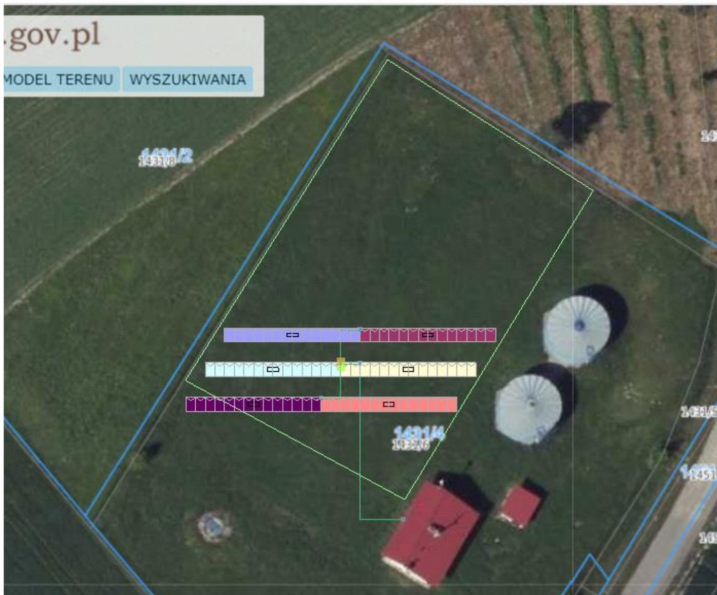
Rysunek 2: Umieszczenie generatora fotowoltaicznego i grupy przetwornic
