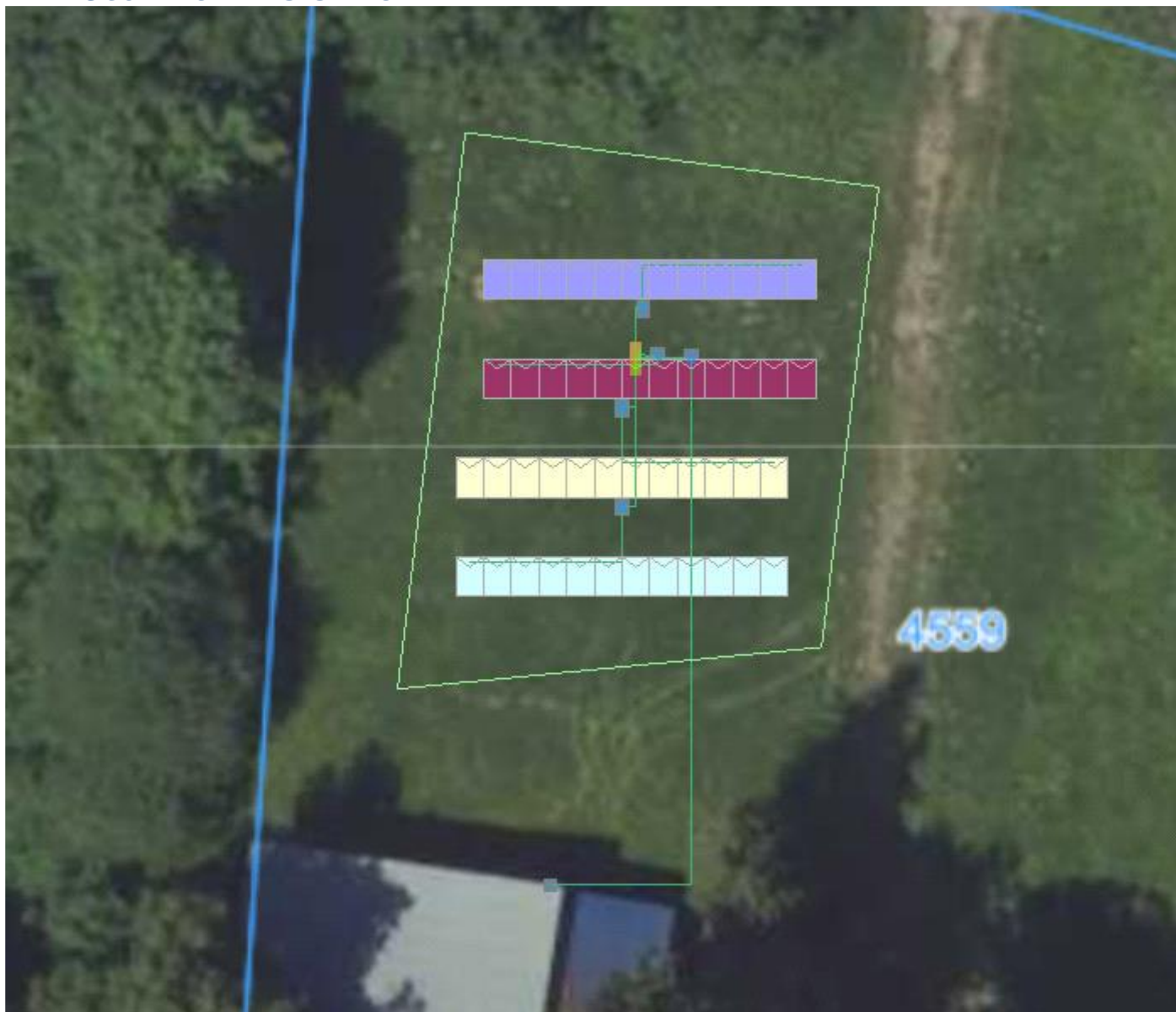
Rysunek 2: Umieszczenie generatora fotowoltaicznego i grupy przetwornic
